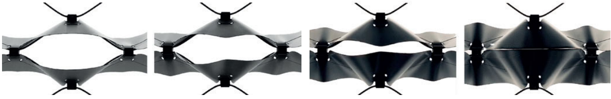
Resim 5. Adaptex Wave'in şekil hafızalı alaşım ile sıcaklığa bağlı olarak kapanışı.
