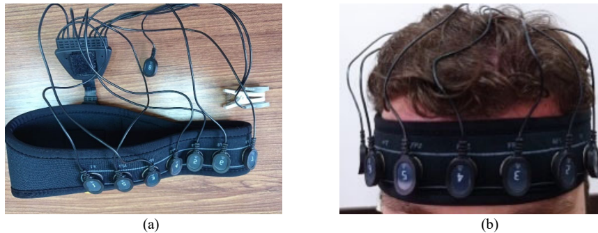
Şekil 1. (a) EEG ölçümü için kullanılan kafa bandı (headband) ve (b) deney anından bir görüntü
