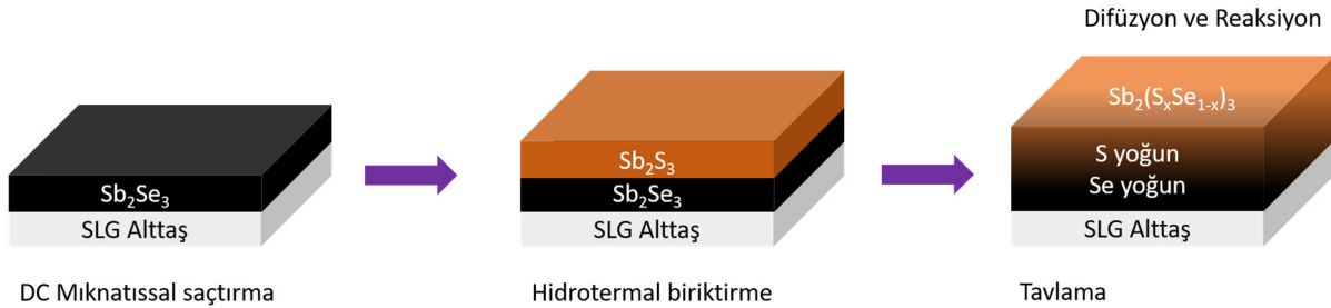
Şekil 1. Kademeli bileşime sahip Sb_2(S_xSe_{1-x})_3 ince filmin üretim sürecinin şematik gösterimi.
