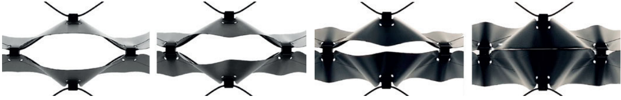
Resim 5. Adaptex Wave'in şekil hafızalı alaşım ile sıcaklığa bağlı olarak kapanışı.
