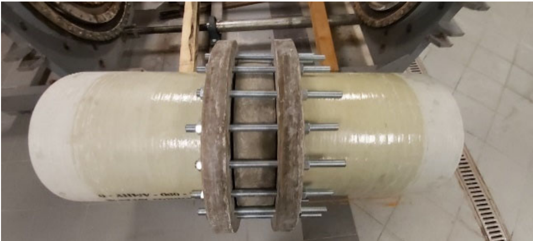
Şekil 11. Bağlantı Tamir Kiti prototipinin 25 \text{ Bar} basınçta deneysel doğrulaması.
